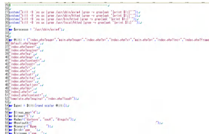
図 23 Exim の脆弱性を悪用する攻撃で感染する Perl ボットの例
